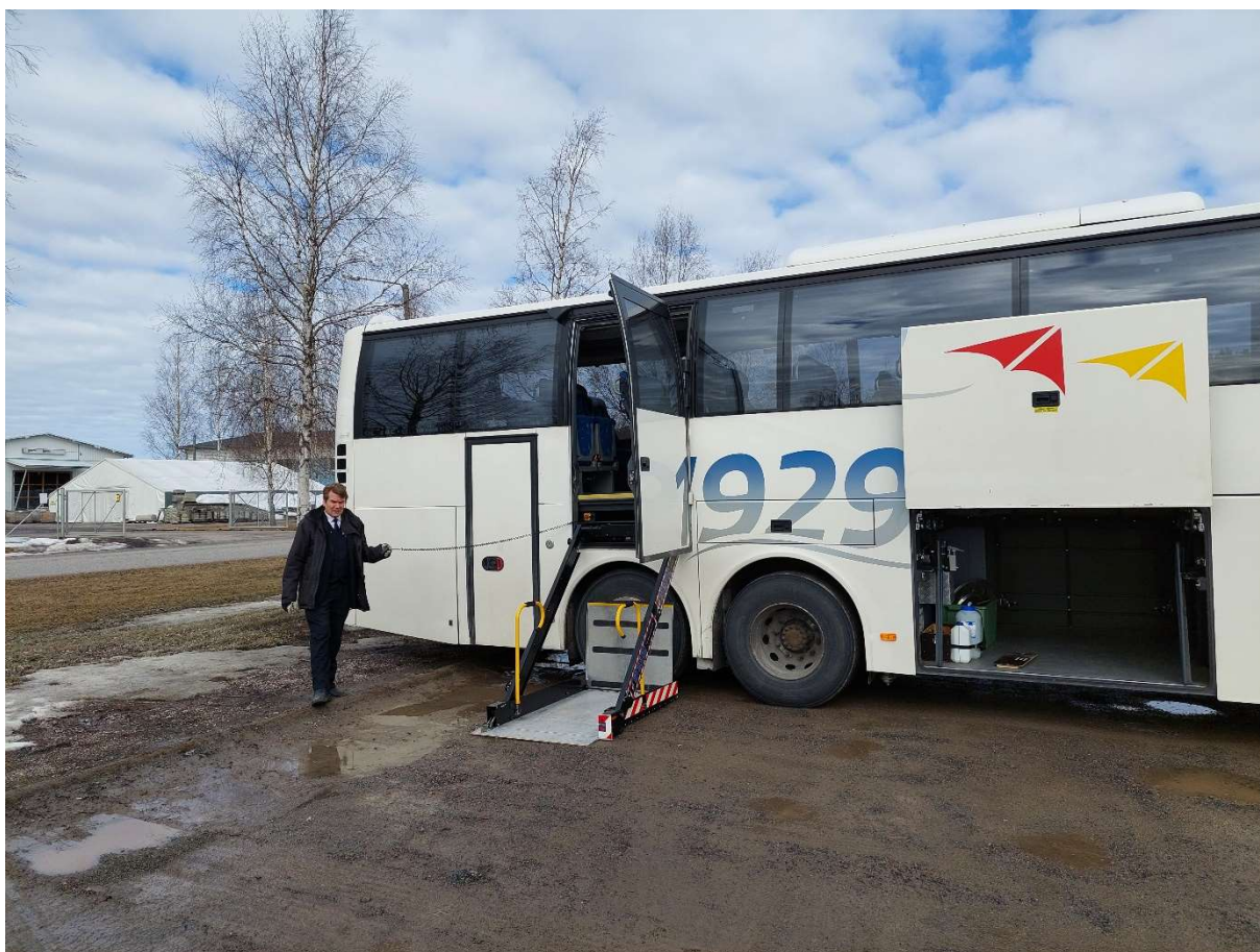
Kuva 34. Esteetön turistivarusteltu linja-auto varustettuna pyörätuolinostimella.
